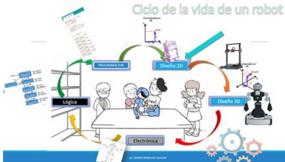
FIGURA 3. Se muestran los pasos para la creación de un robot genérico, desde el diseño 2d, diseño 3D, electrónica, lógica de los procesos del robot y su programación. Estos pasos conllevan previamente a las 7 preguntas de la construcción de un robot.
