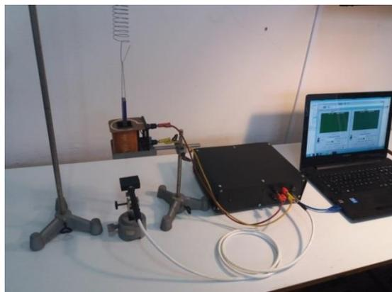
**FIGURA 2.** Montaje experimental para la demostración de la ley de inducción de Faraday.
